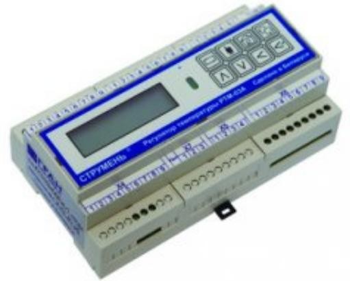
Регулятор температуры РТМ-03А "Струмень" позволяет управлять тремя независимыми контурами регулирования: 2 контурами отопления, контуром ГВС и контуром подпитки. Тип системы определяется количеством контуров. Программа управления с интуитивно понятным интерфейсом позволяет максимально быстро и удобно осуществлять настройку и управление функциями контроллера. Каждый из контуров регулирования свободно программируется под требования заказчика. Число систем регулирования кодируется.
