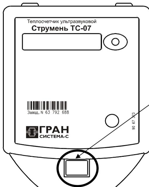
Место нанесения знака поверки в виде клейма-наклейки
