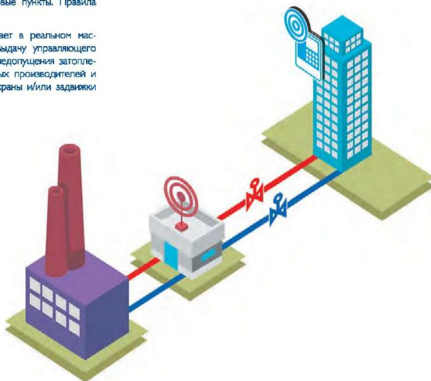
Детектор утечек «Струмень LCB-01» в реальном масштабе времени анализирует данные потока теплоносителя в подающем и обратном трубопроводах в соответствии с заданным алгоритмом расчета. В качестве приборов учета расхода, устанавливаемых в подающем и обратном трубопроводах, могут применяться расходомеры, имеющие импульсный выход с программируемым весом импульса пропорционально расходу теплоносителя.
