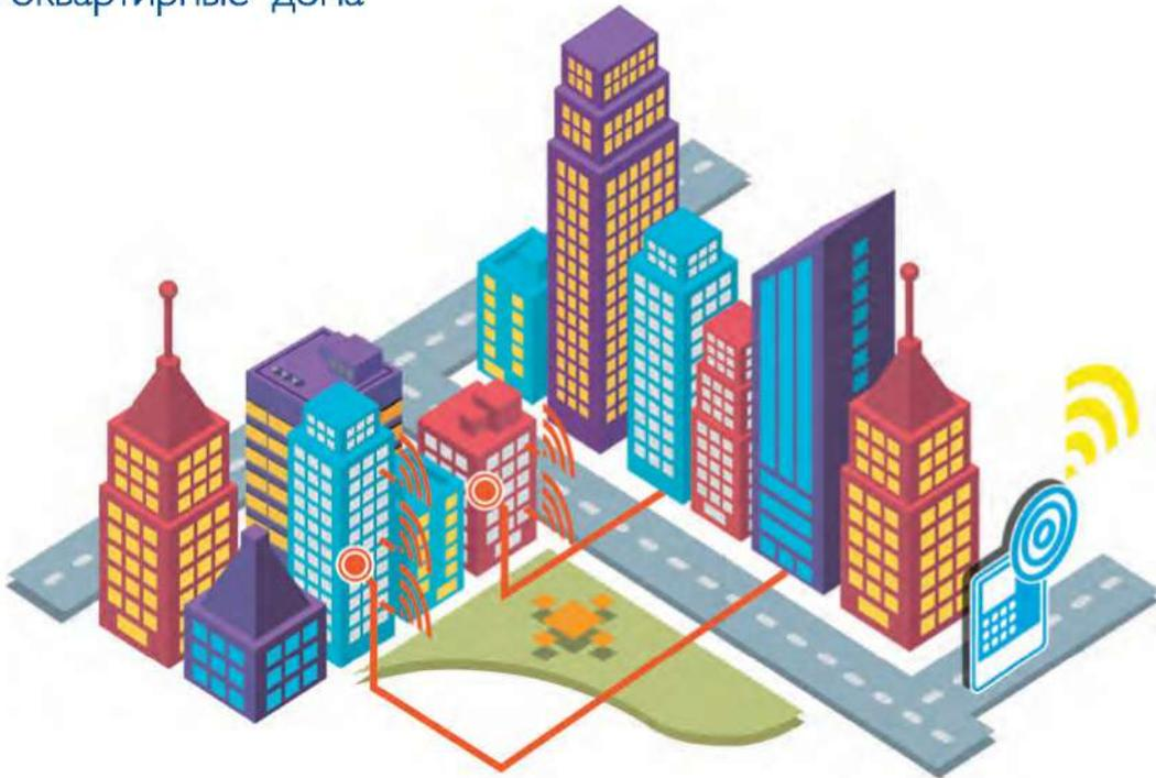
В каждом подъезде должен устанавливаться маршрутизатор РМ-01, который будет обслуживать счетчики подъезда. Место установки маршрутизатора выбирается таким образом, чтобы в зоне его покрытия находилось, по крайней мере, два счетчика. Подсети одного дома должны работать на разных частотах. Расстояние от маршрутизатора до самого дальнего счетчика в подъезде не должно превышать 32 этажей. Количество счетчиков, обслуживаемых одним маршрутизатором, – не более 254.
